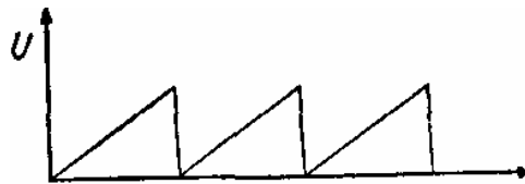
Zeitlicher Verlauf der Spannung bei einer elektrischen Kippschwingung.
